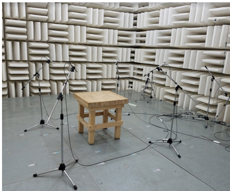
Figura 9: Entorno de prueba en la cámara anecoica de Foxconn CMC con un ruido de fondo de < 6 dBA
